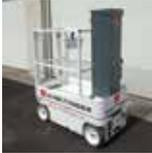
Arbeitshöhe 6,75 m; Gesamtbreite 0,77 m; Plattformaus Schub 0,41 m; Gewicht 971 kg                                                                                          |
