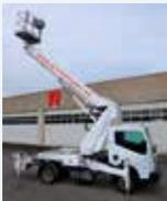
Arbeitshöhe 30,0 m; seitliche Reichweite bis 17,10 m; Gewicht 3500 kg (Führerschein B!)                                                                                   |
