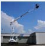
Betrieb wahlweise mit Elektro- oder Verbrennungsmotor, daher für Innen (z.B. hohe Hallen, etc.) und Außen geeignet; Arbeitshöhe 20,8m; Gesamtbreite 2,27m; Gewicht 6640kg |
