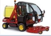
Hochleistungsmäher mit patentiertem "Highspeed" Mähwerk für große Flächen. Ein Gianni Ferrari Turbo schneidet und sammelt außer Gras auch Laub, Papierabfälle, Dosen oder Kunststoffflaschen. Dies bei einer Flächenleistung zwischen 5.000-15.000 m <sup>2</sup> /h                                         |
