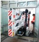
Arbeitshöhe bis 23,0 m; seitliche Reichweite bis 11,2 m;<br>Durchfahrtsbreite 0,79 m bzw. 1,09 m; Antrieb mit Verbrennungsmotor oder elektrisch |
