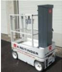
Arbeitshöhe 6,75 m; Gesamtbreite 0,77 m; Plattformaus-schub 0,41 m; Gewicht 971 kg                                                              |
